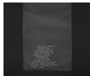
(使用照明:IFHA-C150W) WD = 100mm 表面のハレーションが抑えられ、袋内部の員数検査も容易
